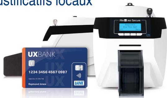
La Rio Pro 360 Secure propose un bac d'alimentation opaque et verrouillable pour sécuriser les cartes vierges. Un deuxième verrou empêche l'ouverture de l'imprimante par toute personne non autorisée et sécurise le couvercle du bac de sortie opaque.
